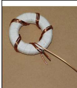
der 1 mm Draht wird am oberen Ende des 1,5 mm angelötet und in der gleichen Richtung geht's weiter..
