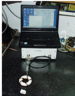
Mit dem Netzwerktester und einem Netbook wird die Rückflussdämpfung festgestellt, wenn der Breitbandtransformator mit  $300 \Omega$  abgeschlossen ist. Von 1,8 MHz bis 50 MHz werden bessere Werte als SWR 1,12 erreicht. (das sind 25 dB Reflexionsdämpfung = sehr gut, für Amateurzwecke mehr als ausreichend)
