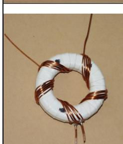
...wo der 1mm Draht angelötet wird. Wieder geht es sieben Mal durch den Kern, eng an der 1,5 mm Wicklung
