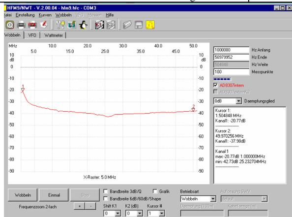
Die Impedanz des Baluns beträgt etwa 100  $\Omega$ . Da der Balun an einer Stelle des Übertragungsweges eingefügt wird, an der mit wechselnden Impedanzen gerechnet wird, macht die Angabe der Eingangsreflexion des Baluns keinen Sinn.
